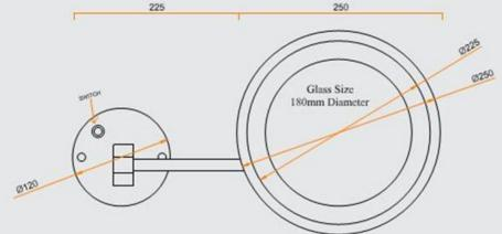
MAXIMUM LENGTH FROM WALL - 470MM LENGTH FROM WALL - 115MM WHEN FOLDED
